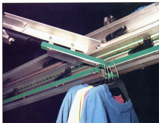
15 elektro-pneumatische Aufgabe in Einschleusstellung
