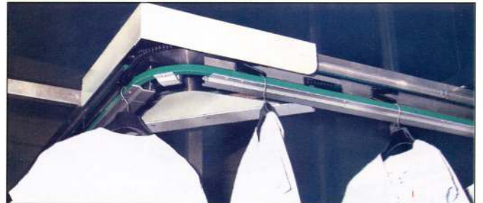
7 Außenkurve 90° (Klinkenförderer vertikal)
