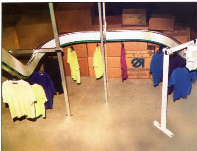
2 Klinkenförderer mit 90°- und 60°-Horizontalkurve sowie 45°-Steigungskurve
