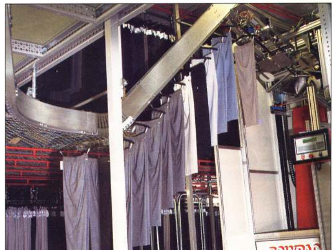
3 Klinkenförderer als Zuförderer zu einer Verpackungsmaschine
